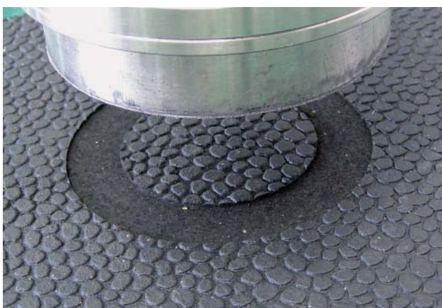
Bild 4: Testmuster nach dem Abriebtest
